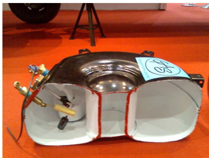
Bak pierścieniowy zewnętrzny multizawór (90° bak)
